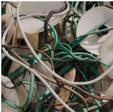
Kabel mit hohen Fremdanteilen
