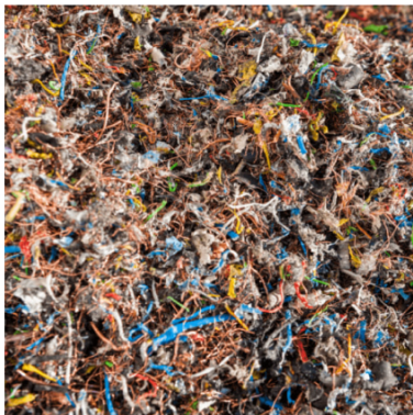
Mittel- & Restfraktionen aus Kabelzerlegung
