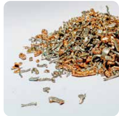
Kupfer mit galvanisierten Anteilen
